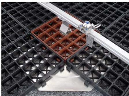
Durch Auflast gehaltene Anschlagseinrichtung gemäss EN 795 Typen D+ E mit horizontal beweglichem Anschlagpunkt für kurzzeitige Arbeiten mit einer Persönlichen Schutzausrüstung (z. B. ZinCo Fallnet® PSA-Set, Art.-Nr. 9024) auf Flachdächern bis max. 5° Dachneigung.
