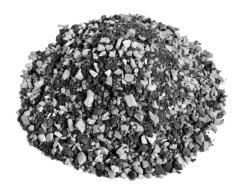
Vegetationssubstrat für extensive Dachbegrünungen in ein- oder mehrschichtiger Bauweise.
