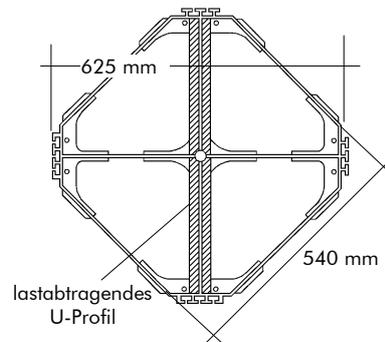
Der Verbund der Elemente erfolgt über integrierte T-Profile
