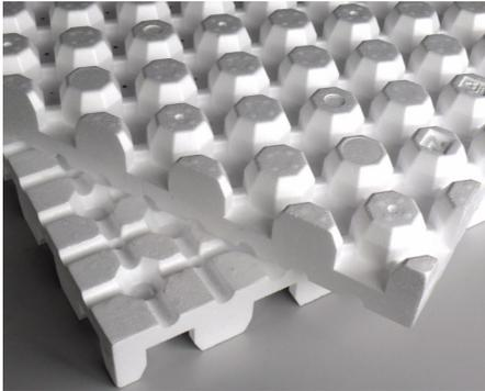
Beidseitig verwendbares Drainelement aus EPS-Hartschaum für den Einsatz bei Extensiv- und einfachen Intensivbegrünungen auf Flach- und Schrägdächern.
