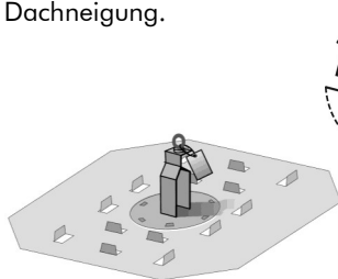
Anschlagpunkt mit Grundplatte, Stütze und Anschlagöse
