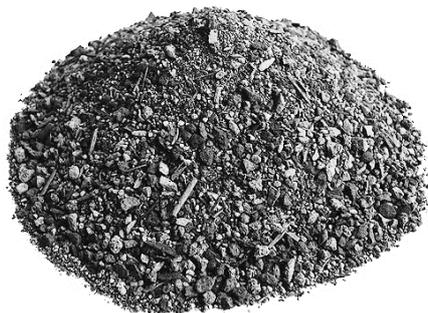
Vegetationssubstrat für Rasenansaat, Rollrasen und für den Systemaufbau „Sommerwiese“ in mehrschichtiger Bauweise geeignet.
