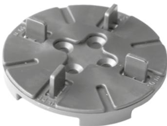
Auflageteller für Plattenbeläge zum Aufsetzen und Verschrauben auf die Auflage-Schienen, mit 3mm Fugenteiler und Auflagescheibe. Fugenteiler sind ausbrechbar.
