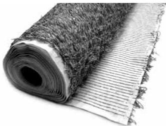
Wasserverteilendes und einseitig mit kapillar wirksamen Fasern bestücktes Vlies aus Polyester; speziell entwickelt für den Einsatz in Verbindung mit dem Wasserverteil-, Speicher- und Dränelement Aquatec® AT 45. Material: Polyester; Farbe: weiss (Vlies), grau (Fasern); Flächenmasse: ca. 600 g/m<sup>2</sup>; Faserlänge: ca. 40 mm.
