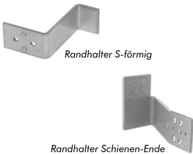
Randhalter in S-Form zur Einfassung von Plattenbelägen mit einer Auskrägung von 60 mm und einer Aufkantung von 30 mm und seitlich anbringbarer Randhalter zur Einfassung von Plattenbelägen am Schienenende, jeweils mit speziellen Noppen zur Verdrehsicherung.
