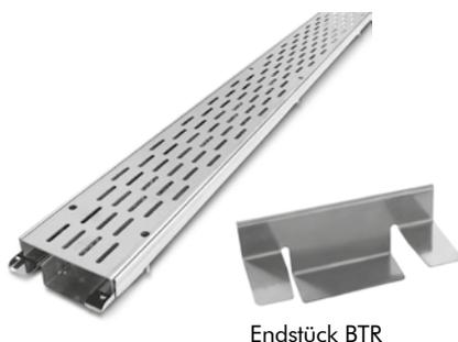
Höhenverstellbare Rinne aus hochwertigem Edelstahl; Abdeckung mit Langlochschlitzung, Rinnenkörper unten/seitlich geschlitzt, einschliesslich Stossverbinder. Rinnenbreite: ca. 107 mm; Breite der Abdeckung: 100 mm; Höhenverstellbereich: ca. 40 bis 55 mm.
