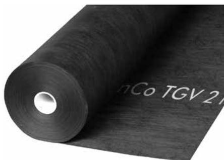
Luft- und dampfdurchlässiges, jedoch wasserabweisendes, thermisch gebundenes Vlies aus 100 % Polypropylen; einsetzbar als Trennlage bzw. Rieselschutz, z. B. bei begrüntem Umkehrdächern, zum Schutz von Metallen gegen schädigende Einwirkungen angrenzender Stoffe, etc.; chemisch und biologisch neutral; bitumen- und polystyrolverträglich; beständig gegenüber Säuren und Alkalien; diffusionsoffen ( $s_d \leq 0,01$  m); Farbe: schwarz; Dicke: ca. 0,55 mm; Flächenmasse: ca. 80 g/m<sup>2</sup>.
