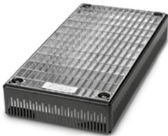
Höhenverstellbare Entwässerungsroste aus verzinktem Stahl mit beschichtetem Kiesfangrahmen. Die grobe Höhenanpassung erfolgt durch Wahl des entsprechenden Kiesfangrahmens; bei Bedarf in Kombination mit dem 60 mm hohen Aufstockelement; die Feinjustierung mit einem Schraubendreher von oben, ohne Ausbau des Rostes. Auf diese Weise ist der höhenverstellbare Terrassenrost 40 × 40 für Aufbauhöhen von 65 mm bis 185 mm geeignet.
