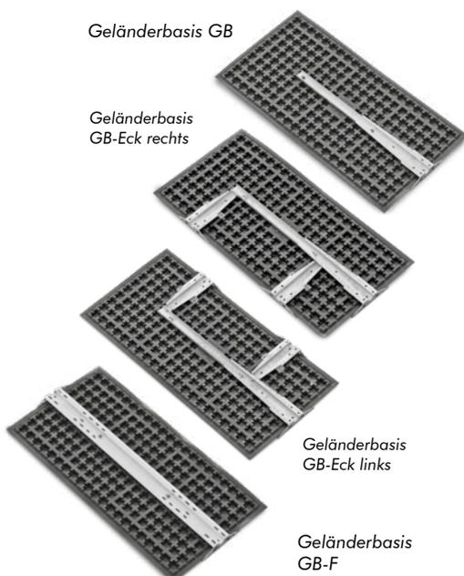
Aus profiliertem ABS-Kunststoff mit unterseitigen Aussteifungsprofilen aus Aluminium, Pfostenaufnahme(n) mit Schraubflansch aus feuerverzinktem Stahl. Universell für Pfosten mit passendem Schraubflansch (Lochabstand 100 mm × 75 mm). Geprüft nach DIN 1055 Teil 3 für Horizontalkräfte bis 1 kN/m, bestehend aus:
