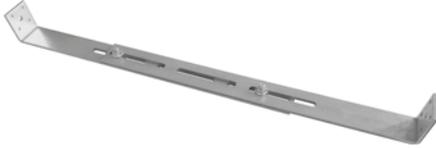
Variabler Abstandshalter zur Herstellung eines Achsmaßes von 350 - 625mm, jeweils mit speziellen Noppen zur Verdrehsicherung.
