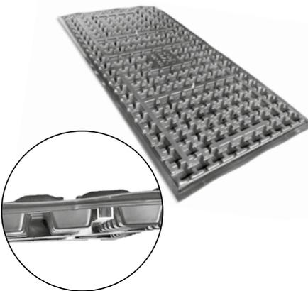
Komplett vormontierte Trägerplatte, z. B. für den ZinCo Solar-Grundrahmen SGR aus tiefgezogenem Recycling-Hartkunststoff mit unterseitigen Konter- und Aussteifungsprofilen aus Aluminium. Plattenmaterial: ABS; Elementhöhe: ca. 43 mm; Gewicht inkl. Aussteifungsprofile: ca. 7,0 kg; Verfüllvolumen: ca. 16 l/m<sup>2</sup>. Befestigungsmittel aus Edelstahl; Gewinde M 10.
