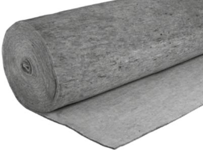
Unverrottbare Synthefasermatte aus einem Polyester/Polypropylen-Gemisch mit stabilisierendem Trägervlies als Einlage; verwendbar als Schutzlage über Wurzelschutzfolien oder Dachdichtungen; besonders hohe Wasserspeicherung; bitumenverträglich; biologisch und chemisch neutral; reissfest; Festigkeitsklasse 4; hergestellt aus Recyclingfasern. Mit geprüfter Schutzwirkung gemäss EN ISO 13428. Wasserspeicherkapazität: ca. 7 l/m<sup>2</sup>; Dicke: ca. 7 mm; Flächenmasse: ca. 650 g/m<sup>2</sup>.
