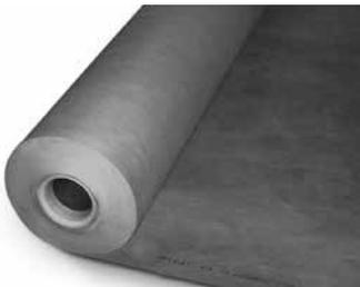
Thermisch verfestigtes Filtervlies aus Polypropylen; **mechanisch hoch belastbar**, daher einsetzbar auf Dränschüttungen; Wasserdurchlässigkeit  $H_{50}$  nach EN ISO 11058: ca. 40 l/(m<sup>2</sup> × s); Öffnungsweite ( $O_{90}$ ) nach EN ISO 12956: ca. 85 µm, Geotextilrobustheitsklasse 3; Flächenmasse: ≥ 175 g/m<sup>2</sup>.
