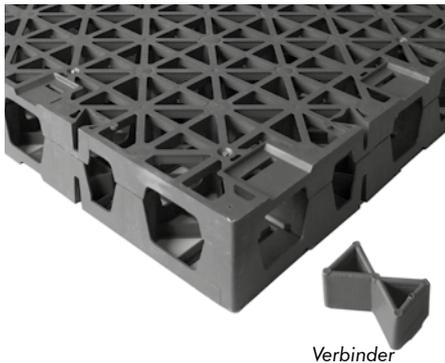
Leistungsfähiges, hochbelastbares und trotzdem leichtes Spacer-Element, im Spritzgussverfahren hergestellt aus Polypropylen, Farbe Grün, Höhe ca. 65 mm bzw. 100 mm; mit innen liegendem Hohlraumsystem; max. Einstauvolumen ca. 60 l/m<sup>2</sup> bzw. 95 l/m<sup>2</sup>; Druckfestigkeit nach DIN EN ISO 25619-2: 500 kPa, zum Einsatz bei Retentions-Gründächern auf Dachflächen ohne Gefälle; auf denen z.B. Geh- oder Fahrbeläge oder hohe Substratschüttungen realisiert werden sollen.
