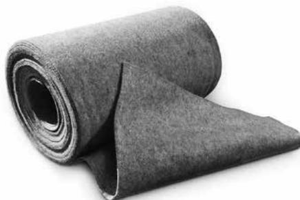
Für den Einsatz in Dachrand- und Anschlussbereichen konzipierter Schutzmatten-Streifen aus Polyesterfasern, insbesondere geeignet für die Kombination mit Fixodrain® XD 20. Als Montagehilfe rückseitig mit Haftkleber besprüht; bitumenbeständig, biologisch und chemisch neutral; Dicke: ca. 3 mm; Flächenmasse: ca. 320 g/m<sup>2</sup>.
