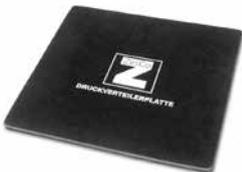
Zum Schutz der Abdichtungsebene vor hohen Punktlasten und damit verbundenen Folgeschäden, wird die Druck-Verteilerscheibe direkt unterhalb des Elastoring verlegt. Die 200 mm × 200 mm grosse Scheibe aus Gummi erhöht den Aufbau um ca. 4 mm.
