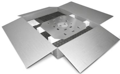
Durch Auflast gehaltene, dachdurchdringungsfreie Anschlagvorrichtung gegen Absturz gemäss DIN EN 795:2012 Typ E, bestehend aus zu einer Scheibe zusammengesteckten und mit Substrat oder Kies überschütteten Rasterelementen und einem im Innenbereich der Scheibe platzierten Anschlagpunkt mit Ringöse.
