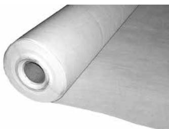
Hitzebeständiges Vlies aus verfestigtem Polyester zum Einsatz auf Elastodrain® EL 202 für den Handeinbau von Asphaltbelägen. Bitte Einbauanleitung beachten! Dicke ca. 1,0–1,4 mm, Flächenmasse ca. 200 g/m<sup>2</sup>, Farbe weiss, Höchstzugkraft min. 400 N/5cm, Reissdehnung längs/quer ca. 35/50 %, Schmelzpunkt > 200 °C.
