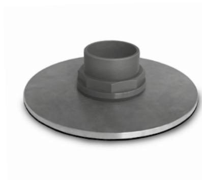
Anstaeuelement zum Aufsetzen auf Flachdachabläufe mit Anschlusskragen und Mindestgrösse DN 100. Gewicht ca. 4,6 kg. Besteht aus einem Edelstahlflansch mit unterseitiger Gummidichtung, Durchmesser ca. 280 mm und einem höhenverstellbarem Überlaufstutzen (Einstellbereich von ca. 10 - 75 mm) aus Kunststoff, Innendurchmesser ca. 75 mm.
