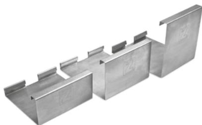
Die ideale Art, die DP-Profile zu fixieren, ohne in die Dachabdichtung einzugreifen. Der DP-Fix-Halter aus Aluminium wird mit einer 750 mm × 500 mm grossen, vorgeschlitzten Fixiermatte geliefert. Als Stossverbinder sorgt er für ein homogenes Erscheinungsbild. Es kann bis zu einer Dachneigung von 5° als Abschlussprofil, zur Einfassung von Begrünungen, als Kiesfangleiste oder als Übergangsprofil (Kies/Begrünung/Plattenbelag) eingesetzt werden. Auf Anfrage auch in Edelstahl erhältlich.
