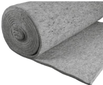
Unverrottbare, thermofixierte Nadelvliesmatte aus Mischfasern; verwendbar als Wasserspeichermatte unter Dachbegrünungen, speziell für geneigte Dächer; bitumenverträglich; biologisch und chemisch neutral; reissfest; hergestellt aus Recycling-Synthefasern. **Wasserspeicherkapazität: ca. 12 l/m<sup>2</sup>**; Dicke: ca. 17 mm; Flächenmasse: ca. 1500 g/m<sup>2</sup>.
