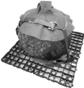
Auflast gehaltenes Baumverankerungssystem; speziell für den Einsatz in Dachbegrünungen entwickelte Wurzelballenverankerung bis ca. 1,0 m Ballendurchmesser. Bestehend aus 3 Ankerplatten ca. 40 x 40 cm, Aluminium/Edelstahl mit Edelstahlschäkel, Rasterelement (RC HDPE) ca. 1,00 x 1,00 m, Höhe ca. 30 mm; inkl. verstellbaren Gurten, die mittels Ratsche befestigt werden; Ratsche abnehmbar; inkl. Kokos-Schutzmatte, Durchmesser 80 cm, Gewicht ca. 17,5 kg
