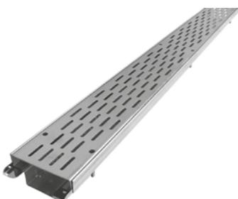
Höhenverstellbare Rinne aus hochwertigem Edelstahl; Abdeckung mit Langlochschlitzung, Rinnenkörper unten/seitlich geschlitzt, einschließlich Stoßverbinder. Rinnenbreite: ca. 107 mm, Höhenverstellbereich: ca. 40 mm bis 55 mm.
