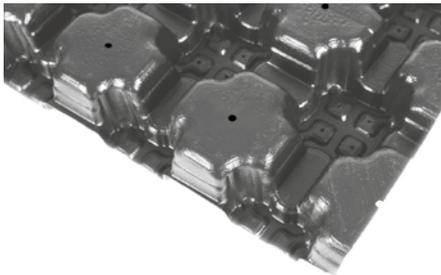
Leistungsfähiges und extrem transportfreundliches Spacer-Element aus tiefgezogenem RC-Polyolefin, Höhe ca. 60 mm; Flächenmasse ca. 2,2 kg/m<sup>2</sup>; mit unterseitigem Mehrriechungskanalssystem und Verbindungsnoppen an Stirn- und Längsseiten, max. Einstauvolumen ca. 55 l/m<sup>2</sup>; Druckfestigkeit nach DIN EN ISO 25619-2: 40 kPa; zum Einsatz bei Retentions-Gründächern auf Dachflächen ohne Gefälle.
