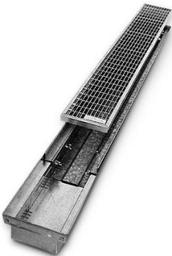
Wie auf Seite 30, jedoch längenverstellbar durch teleskopartig verschiebbaren Rinnenkörper. Der Gitterrost ist entsprechend abzulängen und an der Schnittstelle gegen Korrosion zu schützen. Erhältlich in den Massen 0,60 m – 1,00 m und 1,15 m – 2,00 m; Höhe 50 mm; Gewicht: 5,4 kg bzw. 10,0 kg.
