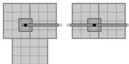
In Verbindung mit Rasterelementen, Schienenhaltern und entsprechender Überschüttung zu montierendes Schienensystem mit horizontal beweglichem Anschlagpunkt, dem sogenannten Läufer; geprüft und zertifiziert als Anschlageinrichtung gegen Absturz gemäss DIN EN 795:2012 Typen D und E.
