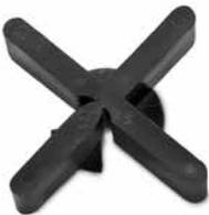
Fugenkreuz, Schenkelstärke 5 mm, Schenkelhöhe 11 mm, aus unverrottbarem Kunststoff; zur problemlosen, zeitsparenden und dauerhaft präzisen Verlegung von Plattenbelägen auf einer Ausgleichsschicht.
