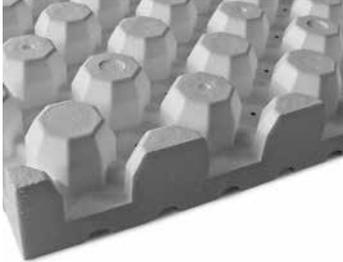
Floraset® FS 75-Elemente bilden das Kernstück des Systemaufbaus „Begrüntes Schrägdach“, der bis ca. 25° Dachneigung eingesetzt werden kann. FS 75-Elemente werden aus EPS-Hartschaum gefertigt; weisen oberseitig stabile Noppen auf, die sich mit dem Substrat verzahnen, und verfügen über unterseitige Drainagekanäle; Füllvolumen (bei Verlegung mit Noppen nach oben): ca. 20 l/m<sup>2</sup>; Flächenmasse: ca. 1,0 kg/m<sup>2</sup>; Höhe: ca. 75 mm.
