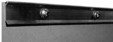
Schlankes Anpressprofil z. B. zur Fixierung von Wurzelschutzbahnen bzw. -folien oder von Teichbahnen an Betonträgern, Winkelsteinen etc.; aus Aluminium-natur; strang-gepresst; vorgelocht im Abstand von ca. 200 mm; Profilhöhe: ca. 40 mm.
