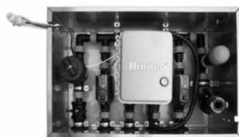
Fertig vormontierte Kopfstation zum Ausseneinsatz für automatisierte Bewässerung speziell von Dachbegrünungen: verriegelbare Edelstahlbox inkl. Kupplung für Wasserzuleitung 32 mm; Filter; Druckminderer; Anschluss für Gartenschlauch; Bewässerungszeitsteuerung durch Batterie (daher kein Stromanschluss erforderlich); 4 Magnetventile 1" inkl. Kupplungen für 32 mm Verlegerohr sowie Regensensor. Gewicht: ca. 14 kg; benötigter Wasserdruck (Fließdruck!): min. 1,5 bar.
