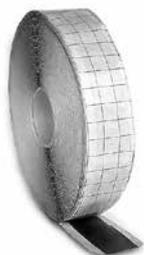
Spezielles Klebeband zum Ankleben der Folien und Vliese an bituminösen Untergrund, an Verwahrungen oder an Beton (Beton mit Haftgrund vorgestrichen); beidseitig klebend. Nur Montagehilfe, Verbindung nicht wurzelfest! Verarbeitungstemperatur ca. 20 °C.
