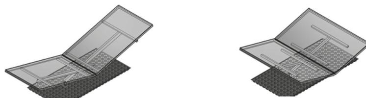
SB PowerGreen bietet variable Montagemöglichkeiten. Die Solarpanels können Portrait oder landscape montiert werden, als SB Solo mit nur einem Panel oder als Duo in Schmetterlingsaufständerung.
