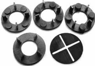
Ringförmige Plattenlager aus Synthetikgummi; Durchmesser 120 mm; in den Fixhöhen 5, 10, 15 und 20 mm. Mit integrierten Fugenteilern in 5 mm Stärke. Elastoring ist auf Dachflächen ohne Pfützenbildung einzusetzen. Geringe Unebenheiten der Dachoberfläche sind durch unterschiedliche Ringhöhen und die 1 mm dicken Distanzscheiben auszugleichen.
