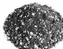
Mit Leichtzuschlagsstoffen angereichertes, blasbares Vegetationssubstrat für Intensivbegrünungen in mehrschichtiger Bauweise.
