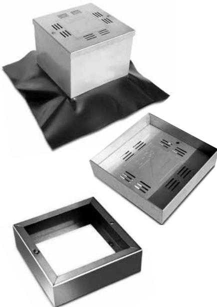
Hochwertiger Kontrollschacht aus **Edelstahl (V2A)** mit ringsumlaufender Schlitzlochung zur Aufnahme von Dränwasser; verschliessbarer, trittstabiler Deckel mit Wassereinlassöffnungen und mit in der Höhe verschiebbarer Folien-Manschette zum lückenlosen Anschluss des Systemfiltervlieses. Farbe: Edelstahl natur; Gewicht: ca. 4,0 kg; Schacht-Aussenmass: ca. 300mm × 300mm; Öffnungsmass: ca. 240mm × 240mm.
