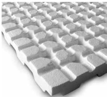
**Dränplatte zum Einsatz unter Extensivbegrünungen auf Flachdächern mit und ohne Gefälle;** aus EPS-Hartschaum; FCKW-frei; ohne HBCD; mit Wasserspeichermulden; Öffnungen zur Belüftung und Diffusion sowie unterseitigem, durchgehendem Kanalsystem; geprüft nach DIN 4095; Rohdichte: ca. 20 kg/m<sup>3</sup>; Flächenmasse: ca. 0,6 kg/m<sup>2</sup>; Höhe: ca. 50 mm.
