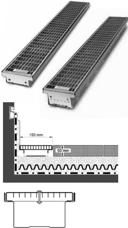
Stabile, an den Stössen verschraubbare Rinne aus Stahlblech, verzinkt und kunststoffbeschichtet, mit begehbarem, feuerverzinktem Gitterrost; sichert den zügigen Abfluss des an Fassaden verstärkt anfallenden Niederschlagswassers; ermöglicht niedrige Anschlusskonstruktionen im Tür- und Terrassenbereich (Sonderlösung nach DIN und Flachdachrichtlinien). Endstücke können bei Bedarf von Hand nach innen geklappt werden (nur bei FR 75); Rost-Maschenweite: ca. 33 mm × 11 mm; Breite: ca. 150 mm.
