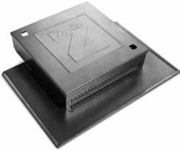
Kontrollschacht aus verzinktem und beschichtetem Stahlblech; mit dreiseitigem Flansch; speziell für in der Attika liegende Abläufe oder Wasserspeier; auch an Aufkantungungen mit Dämmstoffkeil einsetzbar, da Ecken perforiert und ohne Werkzeuge schräg abknickbar; kombinierbar mit den Aufstockelement KSA 8 und KSA 20, siehe oben. Schacht-Aussenmass: ca. 300 mm × 300mm; Öffnungsmass: ca. 240 mm × 240 mm; Flansch an drei Seiten ca. 85 mm.
