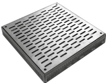
Optisch ansprechender Terrassenrost aus Edelstahl für Aufbauhöhen von 65–95 mm; höhenverstellbar mit Schraubendreher von oben; Abdeckung mit Langlöchern passend zur Optik der BTR-Rinne.
