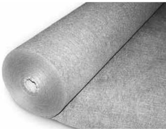
Filtervlies aus vorkomprimiertem und thermisch verfestigtem Polypropylen; verrottungsbeständig; einsetzbar als Filterschicht auf den ZinCo Dränelementen bei **normaler mechanischer Beanspruchung**; Wasserdurchlässigkeit  $H_{50}$  nach EN ISO 11058: ca. 70 l/(m<sup>2</sup> × s); Öffnungsweite ( $O_{90}$ ) nach EN ISO 12956: ca. 95 µm; Geotextilrobustheitsklasse 2; Flächenmasse: ca. 100 g/m<sup>2</sup>.
