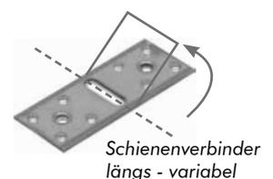
Um das Schienensystem stabil und sicher aufbauen zu können, gibt es je nach Bedarf und Begebenheit verschiedene Verbinder mit speziellen Noppen zur Verdrehesicherung. Diese können passend in die Rillen der Schienen eingesetzt und die jeweiligen Verbinderelemente somit sicher und passgenau verschraubt werden. Alle Verbinder sind aus verzinktem Stahl, sind auf Bestellung aber auch aus Edelstahl erhältlich.
