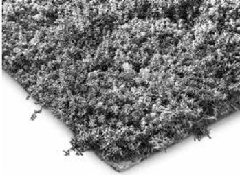
Über eine Vegetationsperiode im Freien vorkultivierte Pflanzenmatten für die schnelle Flächendeckung; speziell geeignet bei Schräg- und Tonnendächern oder windexponierten Dachflächen; mit fest verwurzelten Pflanzen (4–8 bewährte Sedum-Sorten sowie für extensive Dachbegrünung geeignete Kräuter und Gräser) auf einer verrottungsfähigen Trägereinlage; geringfügiger Schrumpf und Fremdbewuchs ist möglich. Liefergewicht: ca. 16–20 kg/m<sup>2</sup>; Dicke: 30–40 mm.
