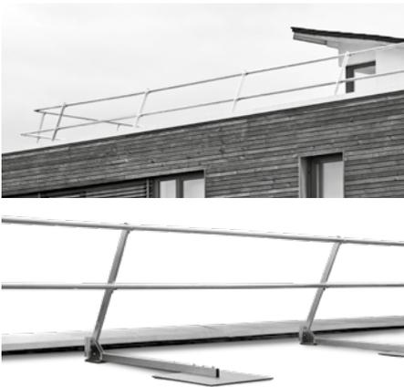
Arbeitsschutzgeländer als Kollektivschutz zur Absicherung bei Wartungsarbeiten auf Dachflächen mit Attika bis 5° Dachneigung als Seitenschutzsystem nach EN 13374 Klasse A. Der Einbau erfolgt ohne Dachdurchdringung mittels vollflächiger Auflast. Das Arbeitsschutzgeländer kann entweder senkrecht oder mit 67,5 Grad Neigung aufgestellt werden. Maximaler Pfostenabstand: 2,6 m.
