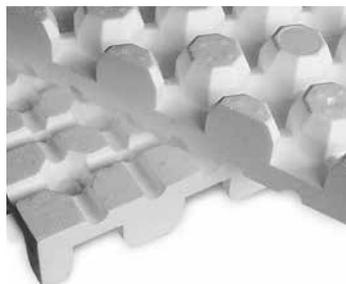
**Beidseitig verwendbare Dränplatte für Extensiv- und einfache Intensivbegrünungen auf Flach- und Schrägdächern (bis 25° Dachneigung, bei Verlegung mit Noppen nach oben);** Dränplatte aus EPS-Hartschaum, ohne HBCD; mit Wasserspeichermulden; Öffnungen zur Belüftung und Diffusion sowie beidseitigem, durchgehendem Kanalsystem; Abflussleistung entsprechend DIN 4095; Füllvolumen (bei Verlegung mit Noppen nach oben): max. ca. 20 l/m<sup>2</sup>; Flächenmasse: ca. 1,0 kg/m<sup>2</sup>; Höhe: ca. 75 mm.
