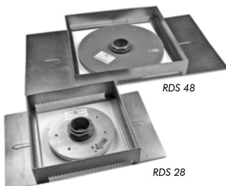
Set bestehend aus **Retentions-Drossel RD 28 + Kontrollschacht KS 10/40** (siehe Seite 25); **Retentionsdrossel** einstellbar, zum Einbau über Flachdachabläufen mit Anschlusskragen, Flansch aus Edelstahl. Überlaufstutzen und Einstellringe aus Kunststoff, Durchmesser Flansch ca. 280 mm; Durchmesser Überlaufstutzen ca. 75 mm; Überlaufhöhe max. ca. 85 mm, Gewicht ca. 4,8 kg.
