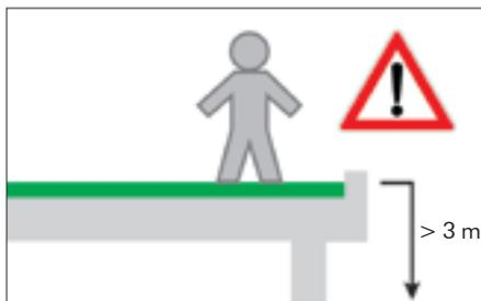
Bei Arbeiten auf Dachflächen, wozu Pflege- und Wartungsarbeiten von Gründachflächen zählen, sind ab einer Absturzhöhe von 3 m Einrichtungen zur Absturzsicherung erforderlich.
