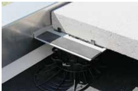
In den Randbereichen sorgt der praktische Randhalter für eine stabile Lage der Platten ohne Kippen. Dank der Aussparungen im Randhalter sorgen die Fugenteiler des Auflagetellers auch hier weiterhin für ein einheitliches Fugenbild.
