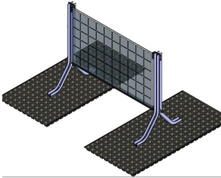
Die vertikale Montage der Bifacial-Module optimiert die Leistung und ermöglicht ein ungehindertes Pflanzenwachstum. Die erhöhte Montageposition der Module minimiert das Risiko von Verschattung durch Pflanzen und der Verdeckung durch Schnee
