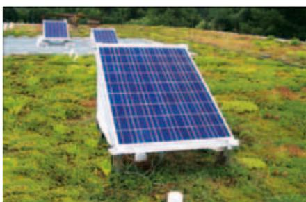
In questo caso sono stati messi a confronto due moduli: uno collocato direttamente sulle guaine bituminose e uno su una copertura verde. Sono state misurate soprattutto le corrispondenti temperature sul lato inferiore dei pannelli.
