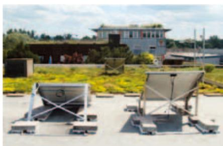
Lors du montage d'essai sur un toit ZinCo, les différences de température des diverses superstructures ont fait l'objet de mesures sur une année complète.
