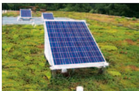
Pour ce faire, deux modules ont été posés sur une toiture nue et un module sur une toiture avec végétalisation. Les mesures de températures ont été principalement effectuées sur la partie inférieure des modules.
