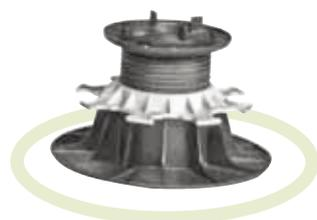
Stufenlos höhenverstellbare Plattenlager aus stabilem Polypropylen zur problemlosen Verlegung von Plattenbelägen auf Flächen mit und ohne Gefälle. Integrierte, 3 mm starke Fugenteiler sorgen für ein lineares Fugenbild mit guter Entwässerungsfunktion. Die einstellbaren Höhen
