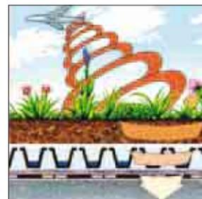
Gründächer mindern die Schall-Reflexion um bis zu 3 dB und verbessern die Schalldämmung eines Daches um bis zu 8 dB. Diese Vorteile kommen bei Bauwerken zum Tragen, die z. B. in Einflugschneisen liegen oder die sehr starke Lärmquellen beinhalten (Diskotheken etc.).
