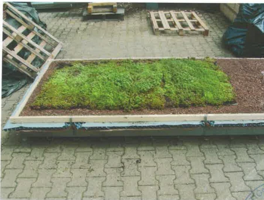
Abb. 8: Aufbau des Gründachsystems mit Vegetationsmatte Built-up of the green roof system with vegetation mat
