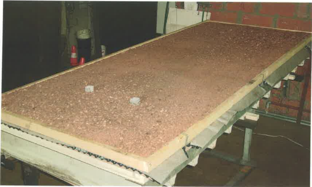
Abb. 10: Probekörper V1 nach den Brandversuchen Specimen V1 after fire testing
