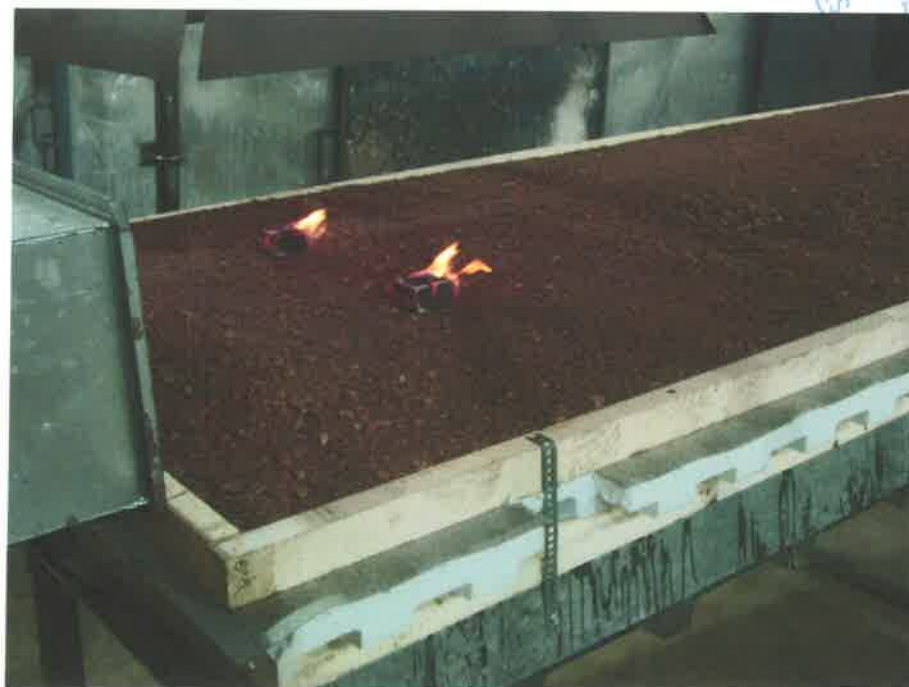
Abb. 6: Anordnung der Brandsätze bei V2
