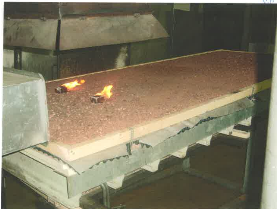
Abb. 3: Anordnung der Brandsätze bei V1 Arrangement of the incendiary compositions V1
