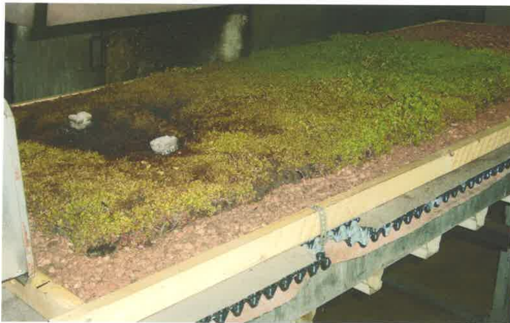
Abb. 12: Probekörper V3 nach den Brandversuchen Specimen V3 after fire testing
