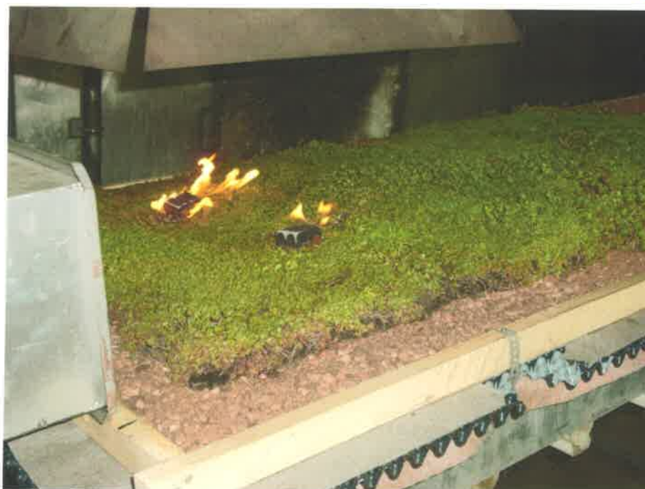
Abb. 8: Aufbau des Gründachsystems mit Vegetationsmatte Built-up of the green roof system with vegetation mat
