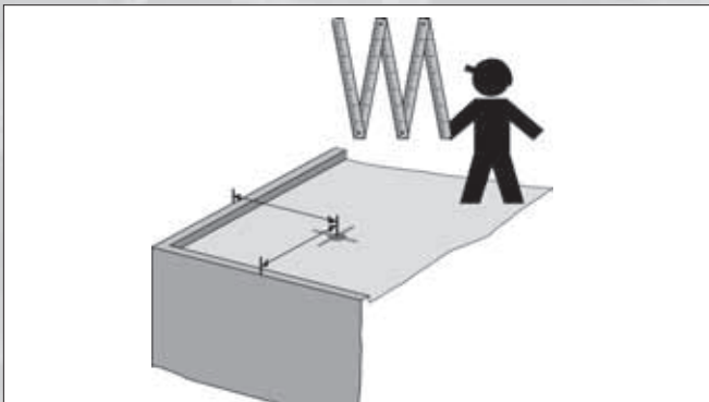
1. Einmessen des Anschlagpunktes
